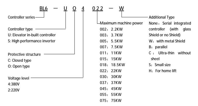
FIGURE 2.1 MODEL DESCRIPTION DIAGRAM
