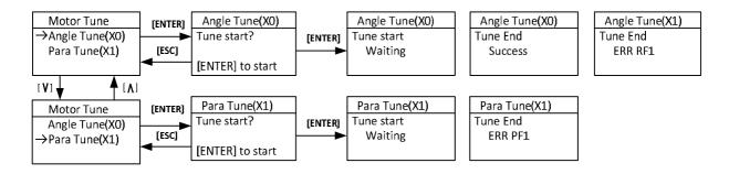
FIGURE 4.13 MOTOR AUTO-TUNING PROCESS
