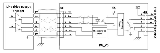
FIGURE 3.12 PG\_V6 CARD CONNECTION TO 5V LONG LINE DRIVE OUTPUT ENCODER (FOR ASYNCHRONOUS MACHINE)
