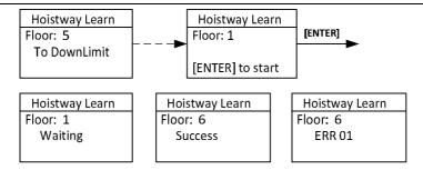
FIGURE 7.5 HOISTWAY PARAMETER SELF-LEARNING PROCEDURES
