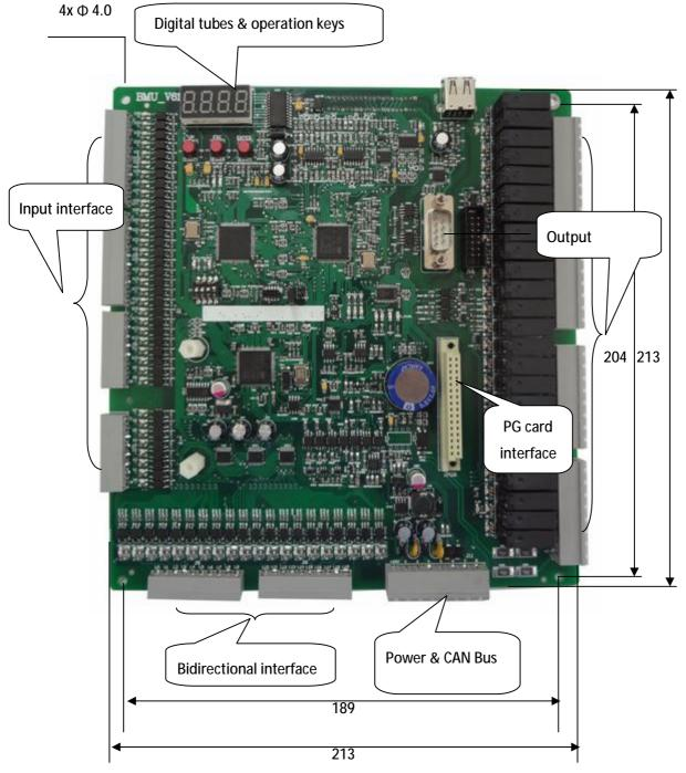
FIGURE 3.4 TERMINAL ARRANGEMENTS FOR CONTROL CIRCUIT
