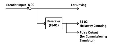
FIGURE 6.15 ENCODER PULSE USAGES
